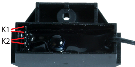
Abbildung 3: Kontakteingänge des Schaltdecoders Illustration #3: Contact inputs of the switch decoder
