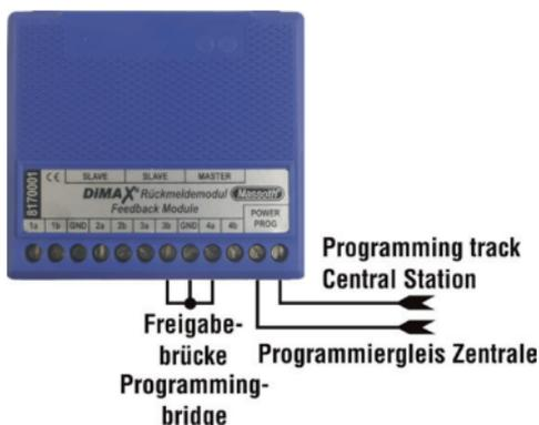
Abbildung 3: Programmiermodus mit Freigabebrücke
