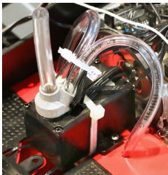
Abbildung 1: Gepulster Verdampfer mit montiertem Zylinderdampfmodul in einer LGB 2080. Illustration #1: Pulsed smoker with installed cylinder steam module in a LGB 2080.
