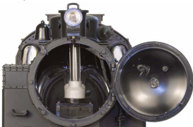
Abbildung 3: LGB 2080 mit eingebautem gepulsten Verdampfer und Zylinderdampfmodul. Illustration #3: LGB 2080 with installed pulsed smoker and attached cylinder steam module.
