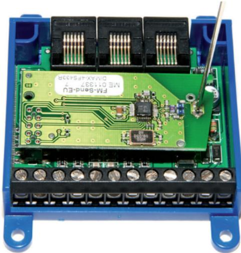
Abbildung 1: Einbau des Rückmeldesenders
