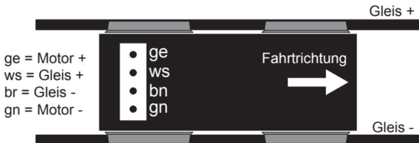
Abbildung 2: Anschluss an ein LGB Getriebe
